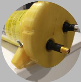
Luego desenrosque la tapa para sacar las pelotas. Para que sea más fácil desenroscar la tapa puede apoyar la pestaña de la abrazadera sobre una superficie plana como muestra la figura. **Nunca ejerza fuerza sobre el tubo, siempre sobre la abrazadera y la tapa**
