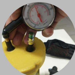
Puede verificar con el manómetro (Accesorio opcional no incluido) la presión exacta en el interior.
